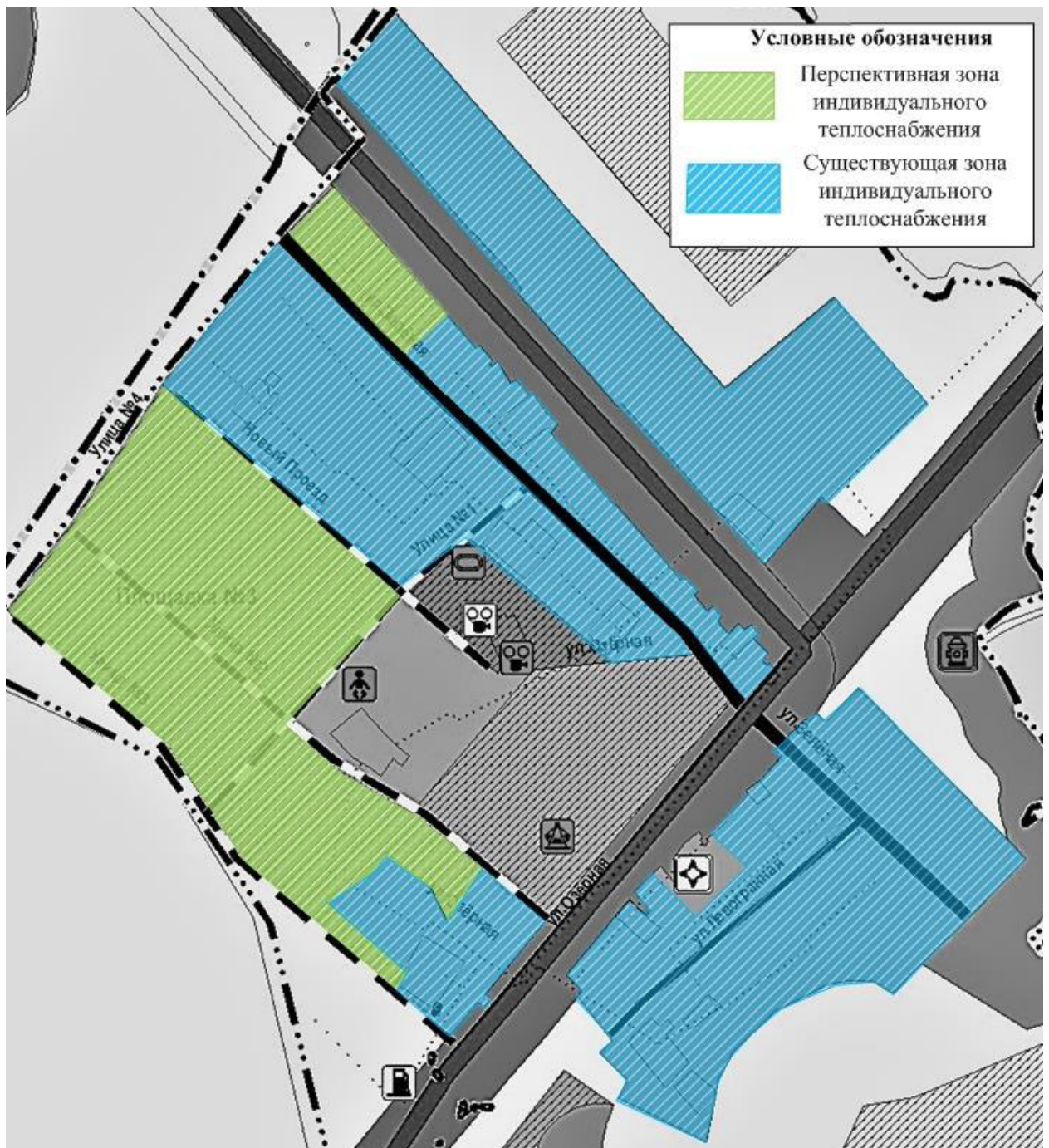
Рис. № 24 - Существующие и перспективные зоны действия индивидуального теплоснабжения на территории поселка Ровный
