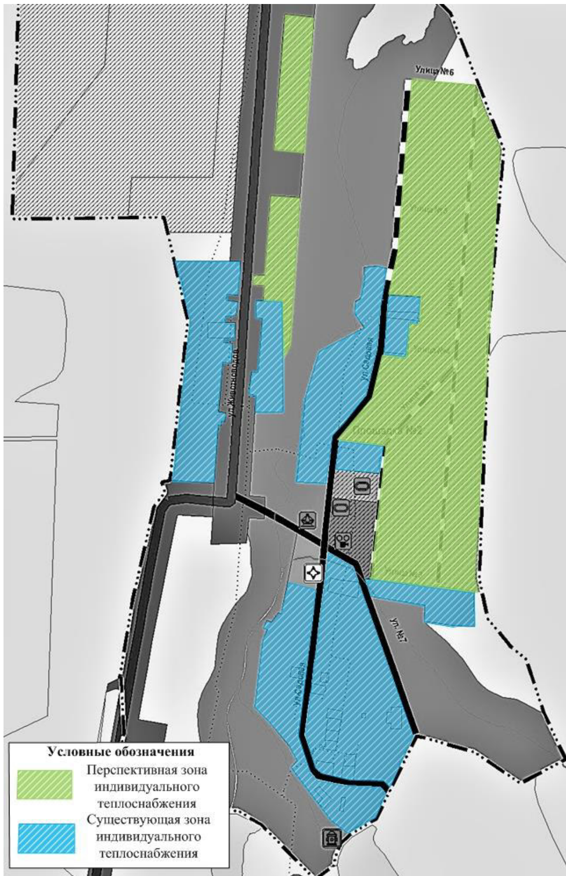
Рис. № 23 - Существующие и перспективные зоны действия индивидуального теплоснабжения на территории поселка Малые Ключи
