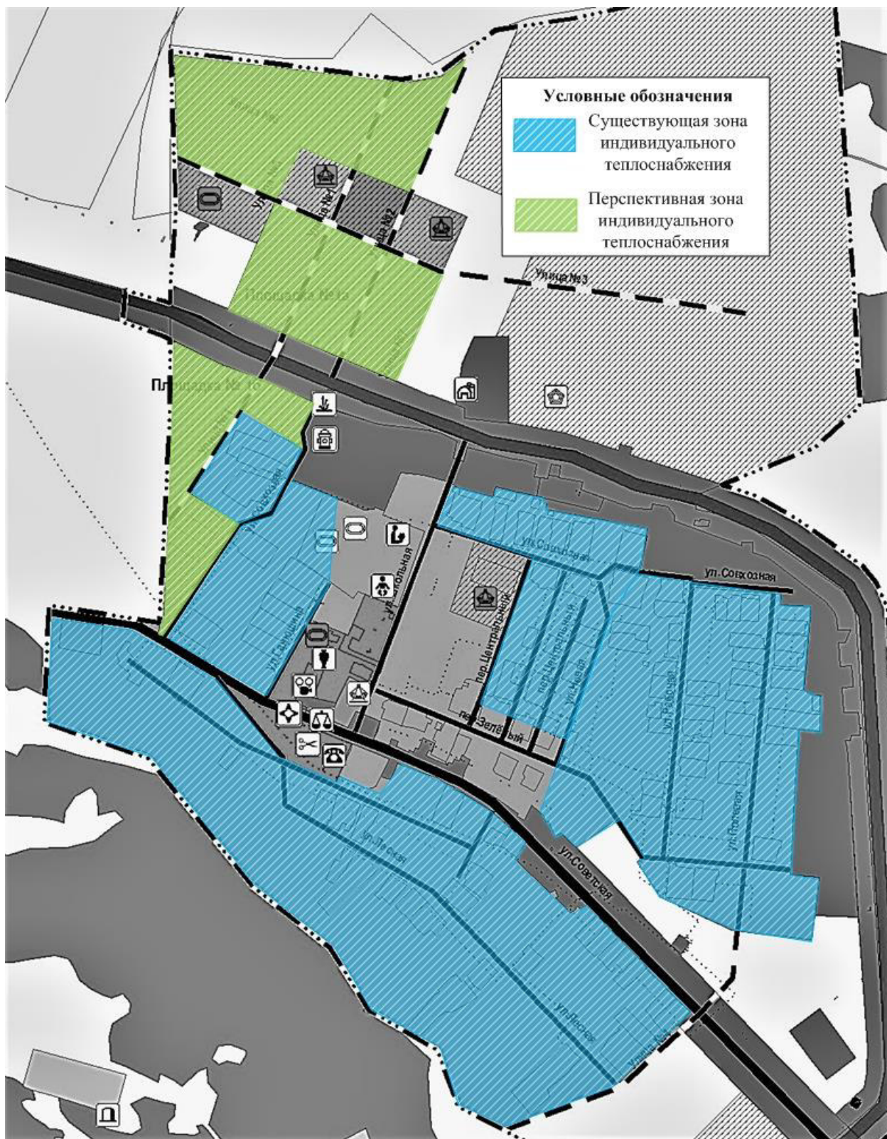
Рис. № 22 - Существующая и перспективная зоны действия индивидуальных источников тепловой энергии на территории села Красносельское
